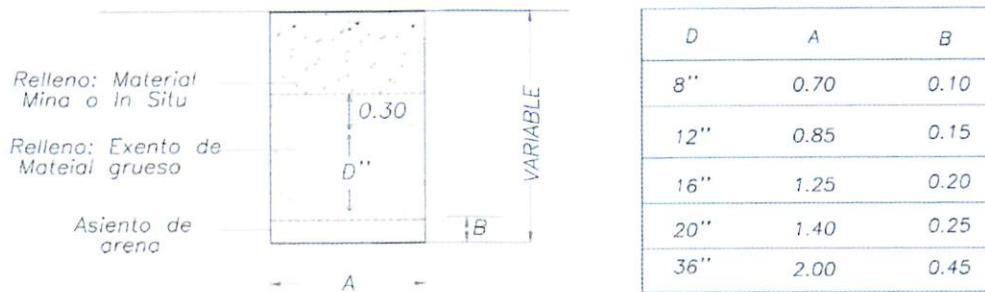
Ilustración 3. Detalle de Zanja.
