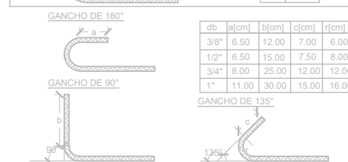
DG DETALLE DE GANCHOS E-01 ESC. 1:15
