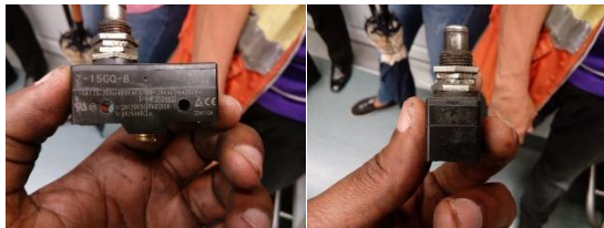
Limitit Switch del freno del motor
