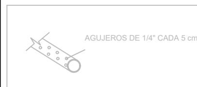
DRENAJE CANALES RECOLECTORES DE AGUA PLUVIAL TERRENO DE JUEGO
