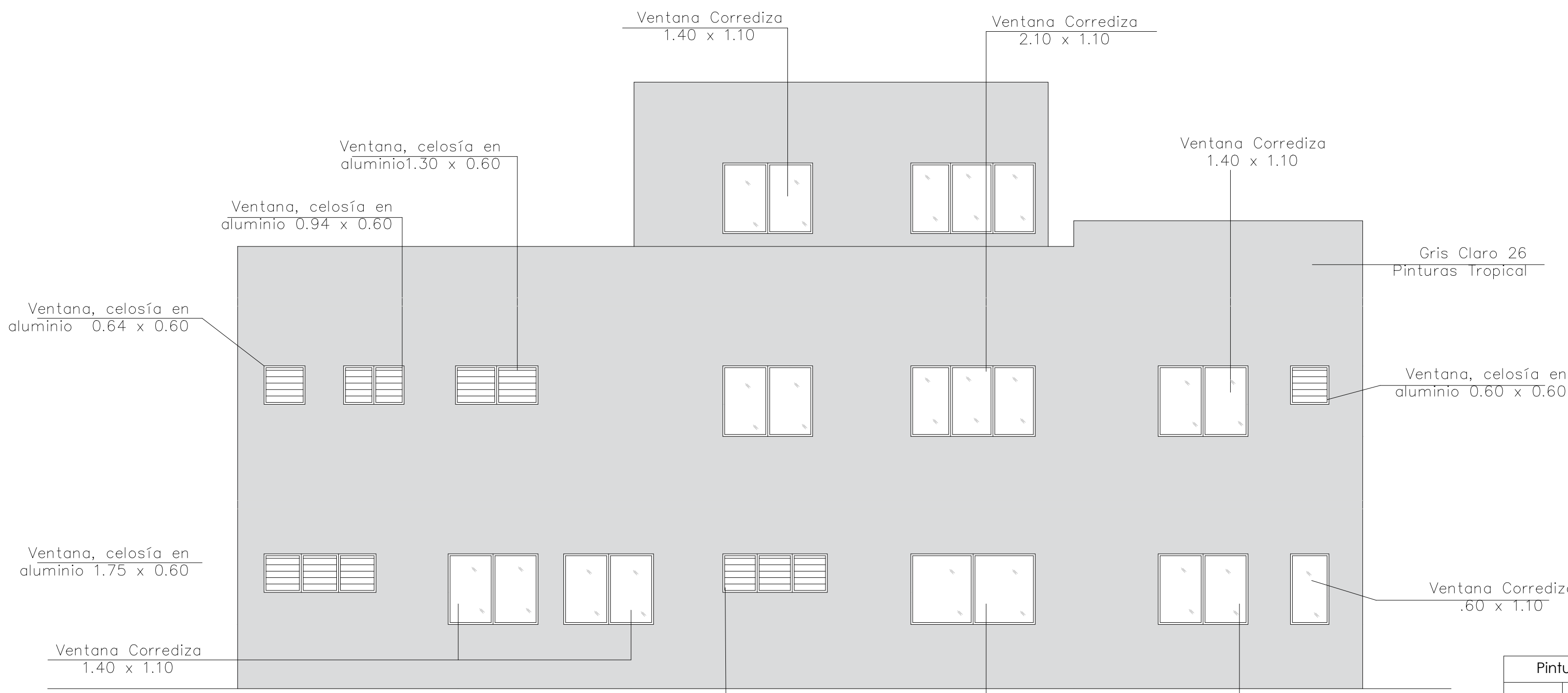
ELEVACIÓN LATERAL IZQUIERDA CON TÉCNICA ESC. 1:100
