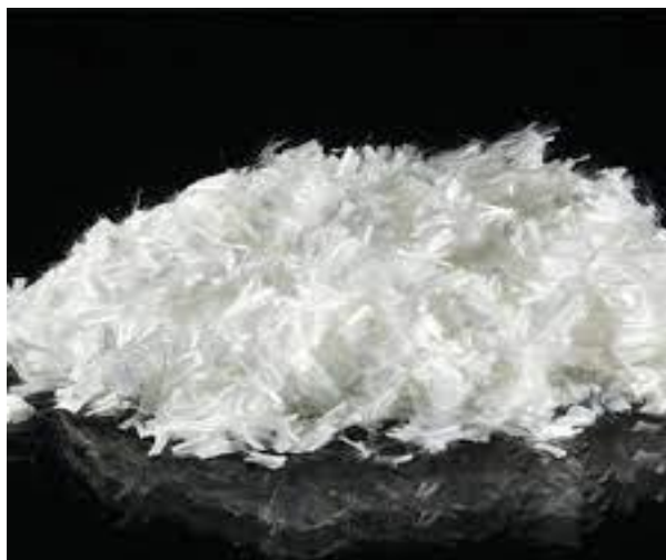
Fibras de monofilamentada utilizadas en la mezcla de hormigón
