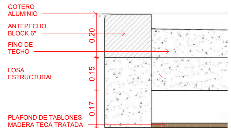
3 Detalle Losa Vuelo 1:10
