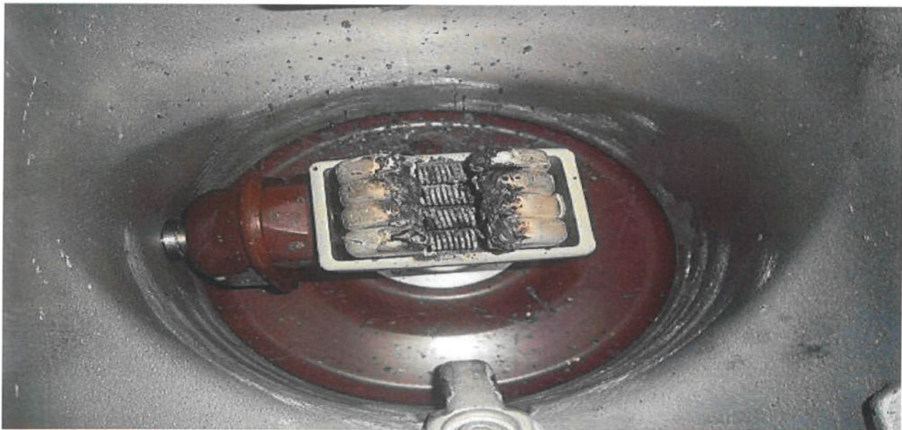
Figura 10. Contacto móvil averiado
