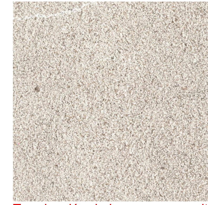
Terminación de bancos en granito flameado color crema
