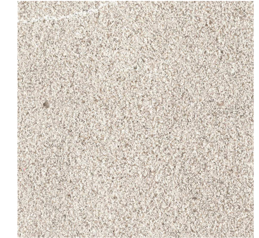
Terminación de bancos en granito flameado color crema
