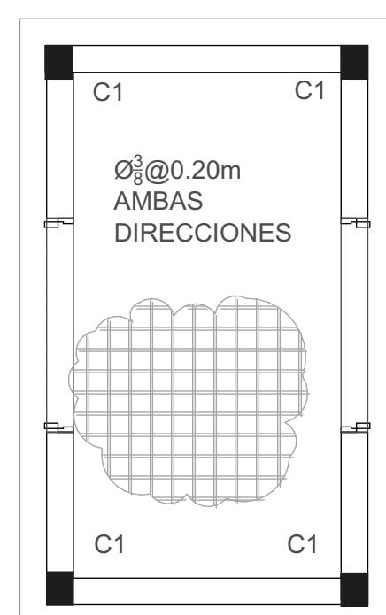
D. Planta de Detalle de Casetas 1:50
